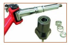
Das Chassis ist serienmäßig mit Achsschenkeln Typ "Racing" und Felgenaufnahmen vorne ausgestattet.
