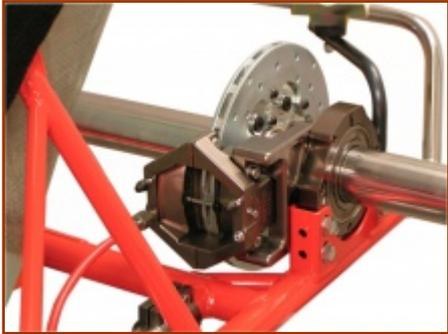
Die Bremse Evo 06 wurde gegenüber dem Vorgängermodell abgespeckt und im Design überarbeitet. Man vertraut hier aber vorerst der bewährten 2-Kolben Technik. Eine selbstnachstellende Version ist in Vorbereitung. Die Bremsscheibe wurde durch eine neu entwickelte Aufnahme schwimmend gelagert.
