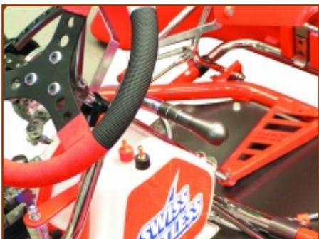
Die Form und die Bauweise des Schalthebels wurde 2006 komplett überarbeitet. Das Gewicht wurde deutlich reduziert und die Bauform den Fahrerwünschen angepaßt.
