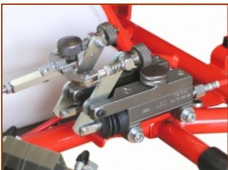
Die Bremskraftverteilung ist ebenfalls überarbeitet und weiterentwickelt worden. Die neue Konstruktion vereinfacht die Verstellung auch während der Fahrt und ermöglicht dem Fahrer eine genauere Justierung der Bremsbalance.
