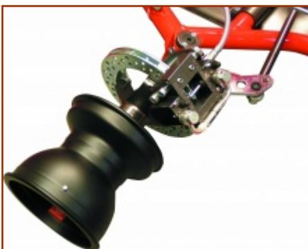
In Bezug auf die Bremse vertraut man bei SH weiterhin der bewährten Bauweise mit schwimmendem Sattel und innenbelüfteter Scheibe. Das System ist sehr zuverlässig und hat sich bei allen bisherigen Einsätzen bestens bewährt.
